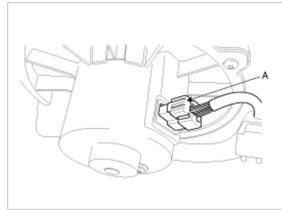
3. 拧下固定螺钉,拆卸鼓风机电机 (A)。
